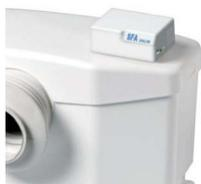
El SANIALARM se compone de un presostato de nivel sumergido que dispara automáticamente el avisador sonoro fijado en el fondo del aparato SFA cuando el volumen de agua supera el nivel máximo autorizado. La alarma produce un sonido continuado hasta que la intervención humana lo desactiva. Y así avisa de los cortes de corriente ocasionales y la elevación anormal de la agua en el triturador!
