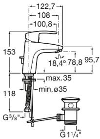
Mezclador monomando para lavabo con aireador, tragacadenilla y enlaces de alimentación flexibles. Apertura en agua fría. Cromado.
