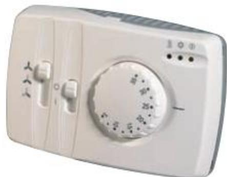
Dependiendo del conexionado eléctrico y de la configuración de 6 microinterruptores, este termostato se puede utilizar para instalaciones de fan-coil a dos tubos, de fan-coil a dos tubos con resistencia eléctrica de apoyo o para fan-coil a cuatro tubos, con **cambio frío-calor exterior**. El cambio frío-calor debe efectuarse mediante un contacto libre de tensión, correspondiendo el contacto abierto al funcionamiento en modo refrigeración del termostato.
