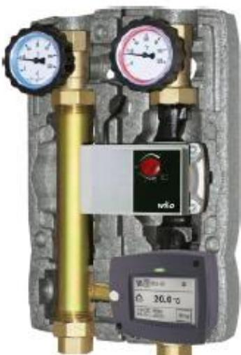
Grupo de bombeo R2 con servomotor/centralita CMP25 para regulación de temperatura variable de impulsión según la temperatura exterior. CMP25 servomotor/centralita digital táctil con sondas de trabajo.
