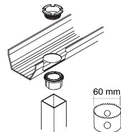
Una solución simple para crear salidas en cualquier posición del perfil.
