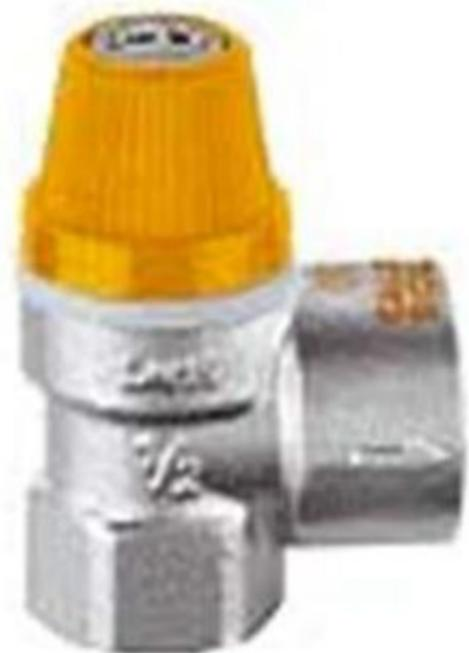
Válvula de seguridad para instalaciones solares. Cuerpo en latón. Cromado. Conexiones Hembra-Hembra PN 10 Campo de temperatura : -30°C a 160°C Porcentaje máximo de glicol: 50% Salida de descarga sobredimensionada Potencia de descarga: 1/2" ( 50 kw) 3/4" ( 100 kw) Homologada por TUV según SV 100 7.7 n° TUV SV 07 2009 Calibraciones: 2,5 / 3 / 4 / 6 / 8 / 10 bar.
